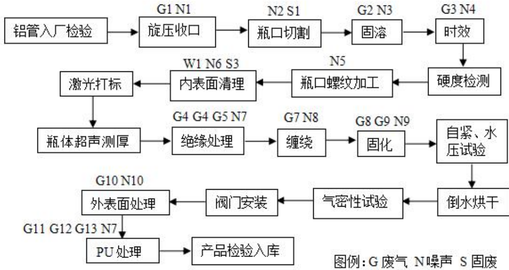
图 6 现有工程高压 III 型铝内胆全缠绕氢气气瓶生产工艺流程
