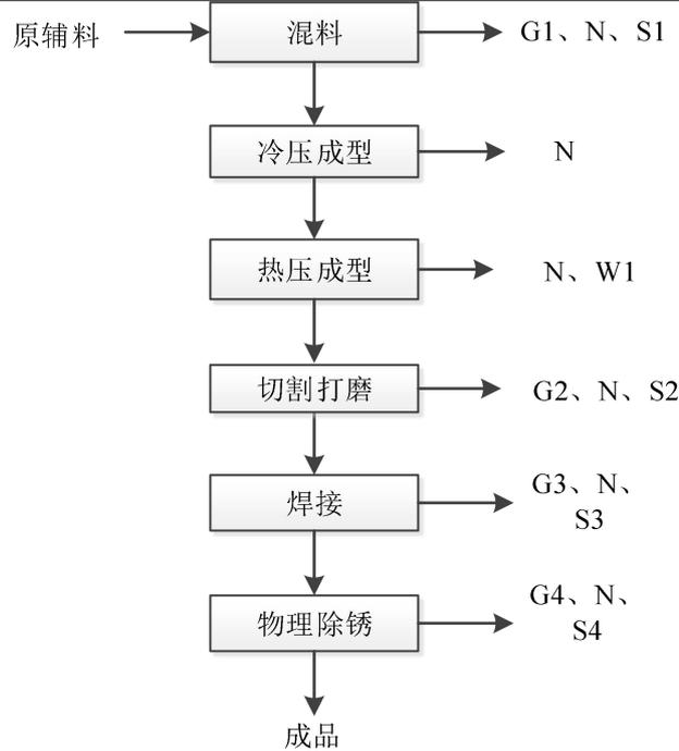
图 2-2 项目生产工艺流程图
